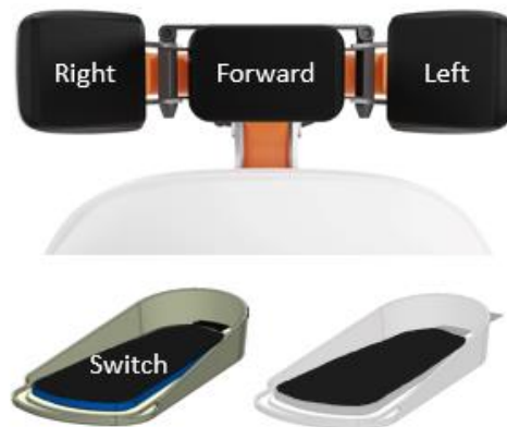
Abbildung 14. Fahren mit dem Hinterkopf – Schalten mit einem Fuß.
