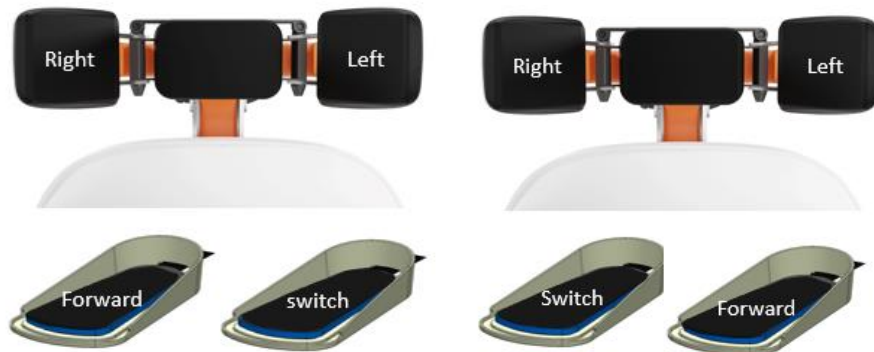
Abbildung 13. Fahren mit dem Fuß – Schalten mit dem Fuß-Konfiguration.
