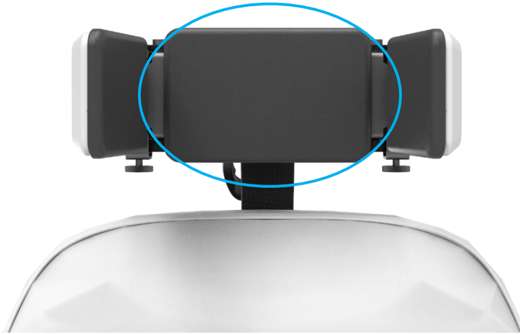
Figuur 7. Achterste pad van de hoofdbesturing waar de krachtensensormatrix is geïntegreerd.
